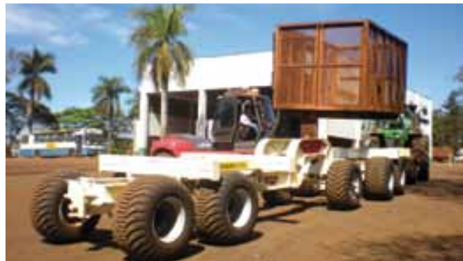
Carreta com células de carga e hectarímetro recebendo um contêiner
