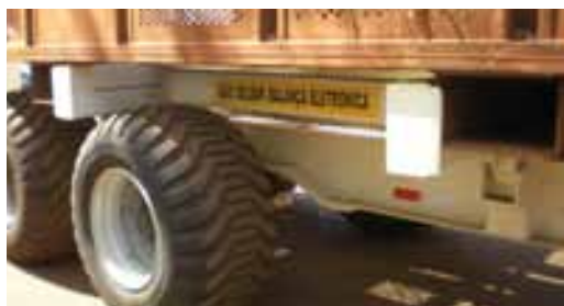
Detalhe da carreta com células de carga na unidade Pedra
