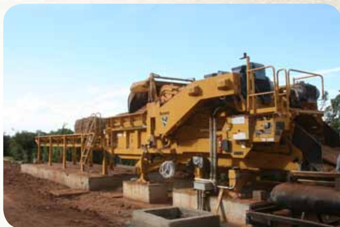
Triturador de palha localizado na área industrial
