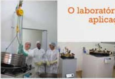
Uma equipe do laboratório faz a limpeza do arroz com água e cloro. Posteriormente, o produto é armazenado em um saco plástico e recebe o fungo através da aplicação com uma seringa.
