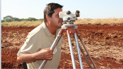
O aparelho mais usado é o "Nível de Precisão"
