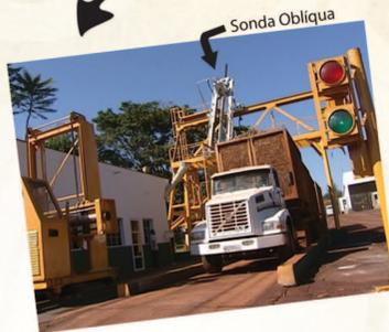
O caminhão chega na usina e passa pela pesagem de cana. Um sistema eletrônico faz um sorteio, o caminhão sorteado vai para o Laboratório de PCTS. As análises do laboratório são feitas por amostragem.
