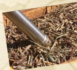
O caminhão para na "posição de furo" e uma sonda oblíqua perfura a carga duas vezes, para coletar as amostras. O primeiro furo é no meio do container de cana, já a segunda coleta é mais profundo, chegando ao fundo da carga.
