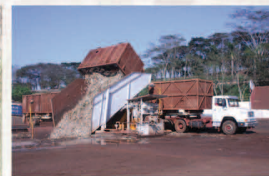
Caminhão com os containers independentes e de uso exclusivo do grupo Pedra. Contipper tomba o container para descarregar a carga
