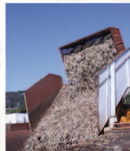
Contipper faz o descarregamento da cana picada
