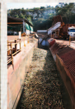
A cana segue em uma esteira que a transporta para o preparo e moagem
