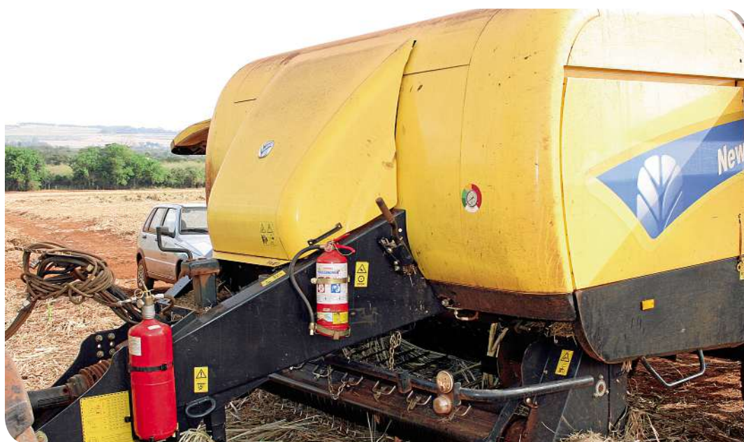
Sistema de combate a incêndio da enfardadora que utiliza o pó químico
