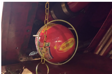
Bola extintora instalada nas colhedoras
