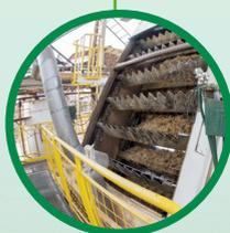
**Extração:** A extração do caldo da cana consiste no processo físico de separação da fibra do caldo da cana. O bagaço segue para as caldeiras para ser queimado e o caldo segue para tratamento;
