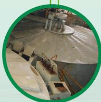
**Tratamento do caldo da cana-de-açúcar:** O tratamento do caldo tem a função de eliminar as bactérias e retirar as impurezas presentes no caldo;
