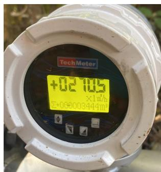
Medidor digital de vazão de água.
