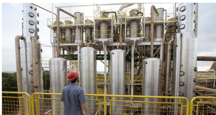
Aparelhos de destilação da Usina Buriti, onde é realizada a separação do etanol. A estimativa de produção de etanol pela Pedra Agroindustrial na safra 23/24 é de 821,6 milhões de litros, dentre os quais 193,8 milhões são de etanol hidratado carburante e 627,8 milhões de litros de etanol anidro.
