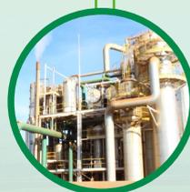
**Evaporação:** Essa etapa consiste na concentração do caldo em níveis adequados para que se tenha uma concentração de açúcares totais (A.T.) próximo de 20% nas Usinas Buriti e Ipê. No caso da Usina da Pedra essa etapa tem múltiplos efeitos e tem a função de preparar o xarope para a produção do açúcar, ao final da etapa de produção de açúcar tem-se a sobra do mel final, que é enviado para a fermentação.
