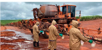
Auditoria da vazão de cada bico de pulverização.
