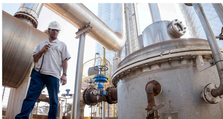
Após a centrifugação e separação das leveduras do "vinho" que tem em sua composição o etanol e a vinhaça, a mistura é destilada sob alta pressão para obtenção do etanol hidratado.
