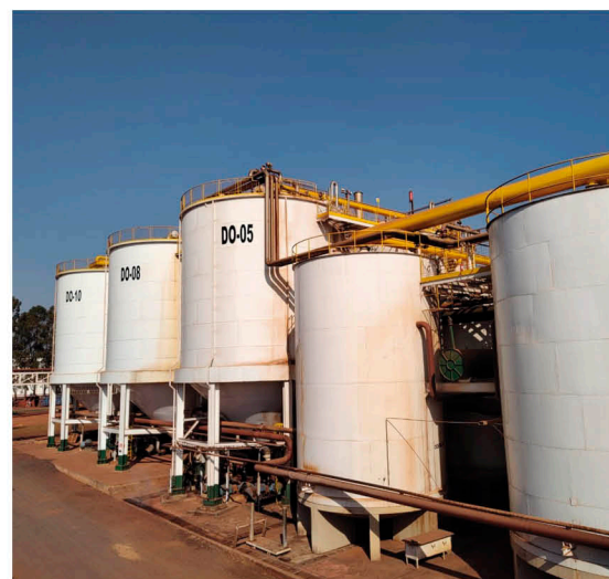
Área de fermentação da Usina Buriti: etanol hidratado passa por mais uma etapa de destilação com líquido que “sequestra” a água.
