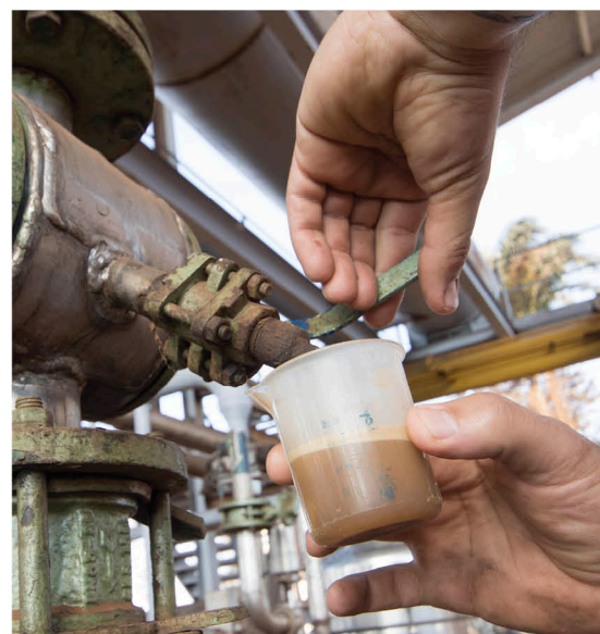
O processo de fermentação é acompanhado por meio de análises físico-químicas e microscópicas em amostras realizadas nos laboratórios das unidades
